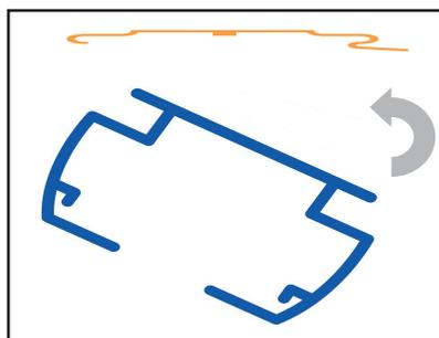
Una volta posizionati gli attacchi fissare il binario ad essi esercitando una pressione come illustrato in figura. Quando il binario è fissato agli attacchi in modo stabile inserire le bande di tessuto ai rispettivi carrellini forniti di opportuni ganci.
